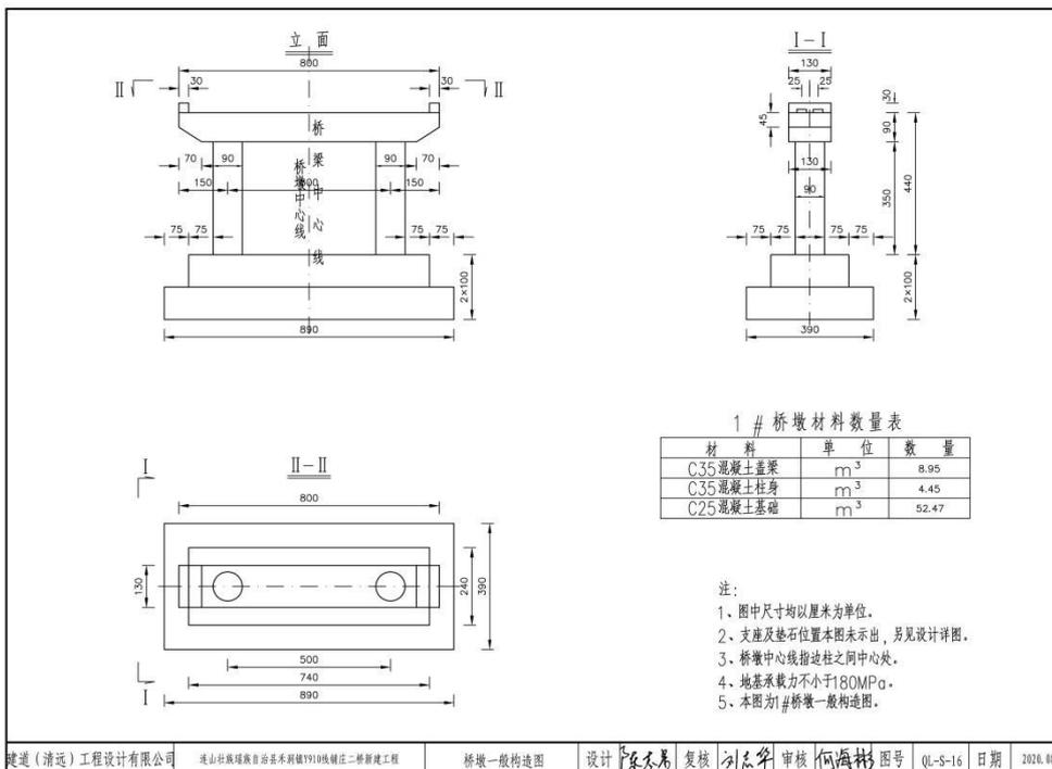
建道（清远）工程设计有限公司 连山壮族瑶族自治县禾洞镇1919线镇庄二桥新建工程 桥墩一般构造图 设计 陈冬卷 复核 刘志华 审核 何海彬 图号 QL-S-16 日期 2020.08
