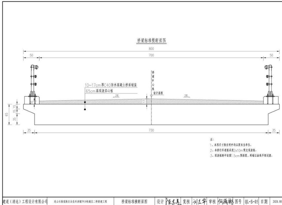
图1-2桥梁上部横断面构造图
