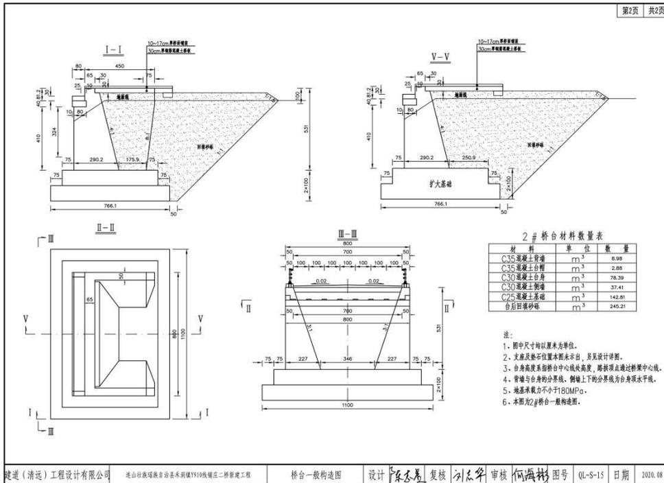
建道（清远）工程设计有限公司 连山壮族瑶族自治县禾洞镇1919线镇庄二桥新建工程 桥台一般构造图 设计 陈冬卷 复核 刘志华 审核 何海彬 图号 QL-S-15 日期 2020.08
